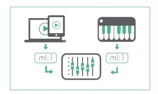
Die ml:1 ist ein kompromissloses plug&play USB Wiedergabegerät, das mit einer passiven DI Box und einem Testtongenerator verbunden wurde. Da die ml:1 die USB Audio Class 1 (UAC1) unterstützt, kann Sie ohne die Installation von zusätzlichen Treibern mit jedem gängigen Betriebssystem verwendet werden. Dadurch ist eine automatische Erkennung des Geräts und eine direkte
