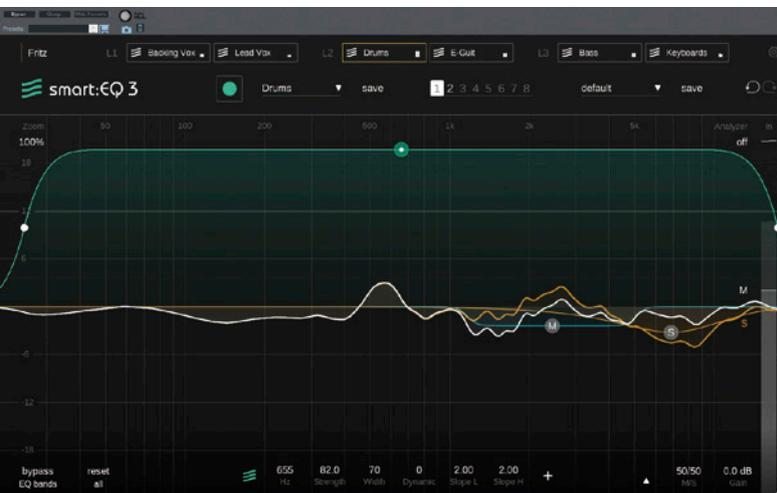
Die gelernte Filtereinstellung wird durch zwei EQ-Bänder, jeweils eines im M- und im S-Kanal. Die weiße Kurve ist das gelernte smart:filter
