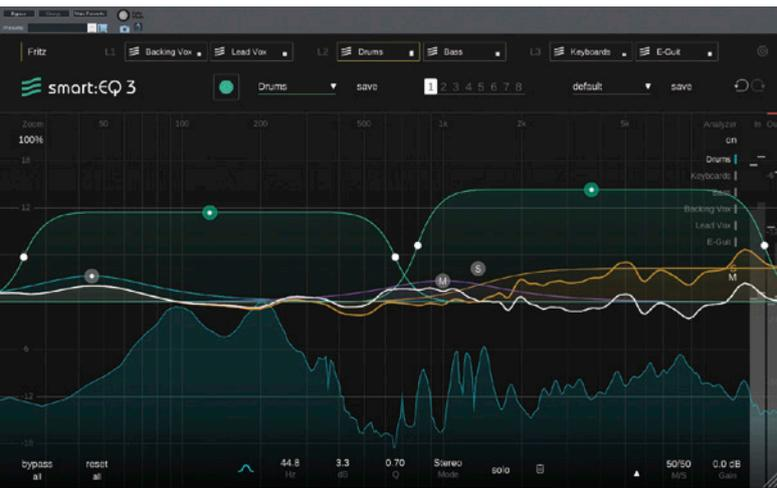
Zwei Gewichtungskurven mit einer M/S-Bearbeitung durch den parametrischen Equalizer
