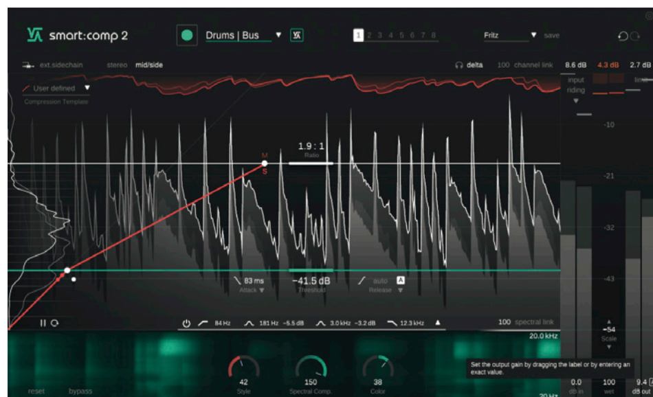
Abbildung 2: Der Breitkompressor dominiert die Bedienoberfläche – hier im M/S-Betrieb mit unterschiedlichem Ausgangspegel
