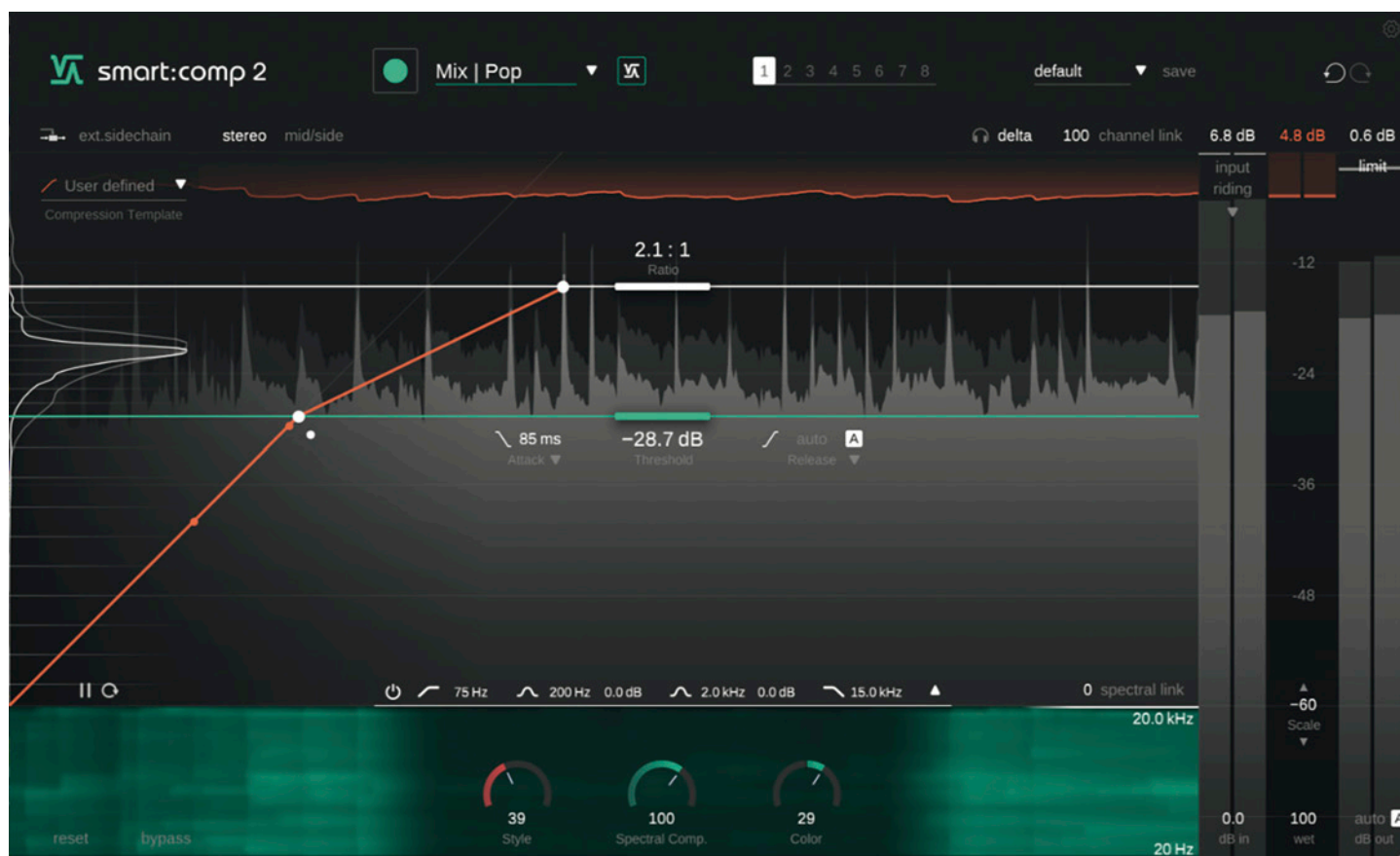
Abbildung 1: Im unteren Displaybereich ist das Echtzeitspektrogramm positioniert, je heller das Grün, desto tiefer der Eingriff des Spektralkompressors
