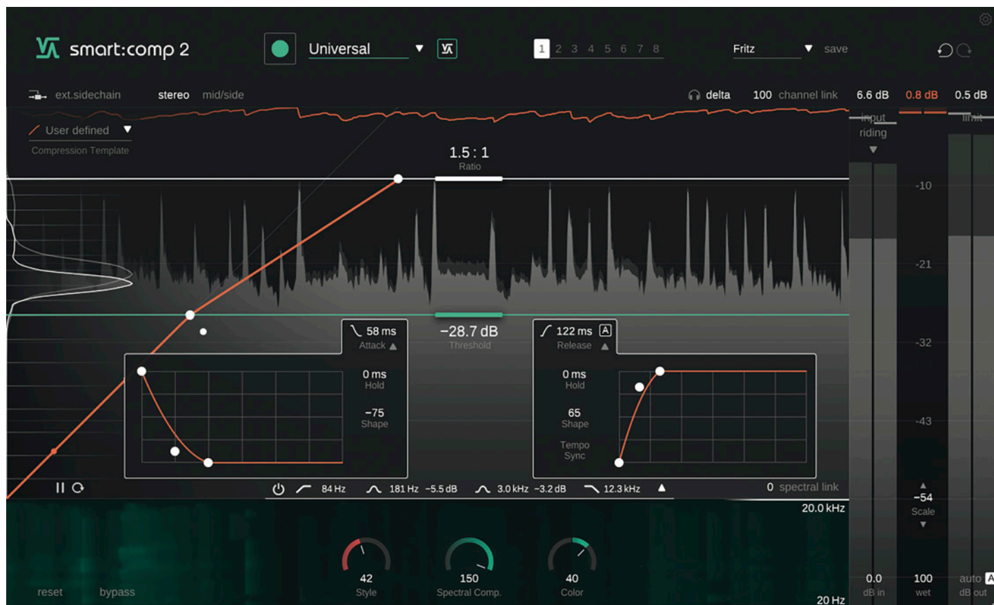
Abbildung 3: Attack und Release mit variabel einstellbarem Kurvenverlauf und Hold-Parameter
