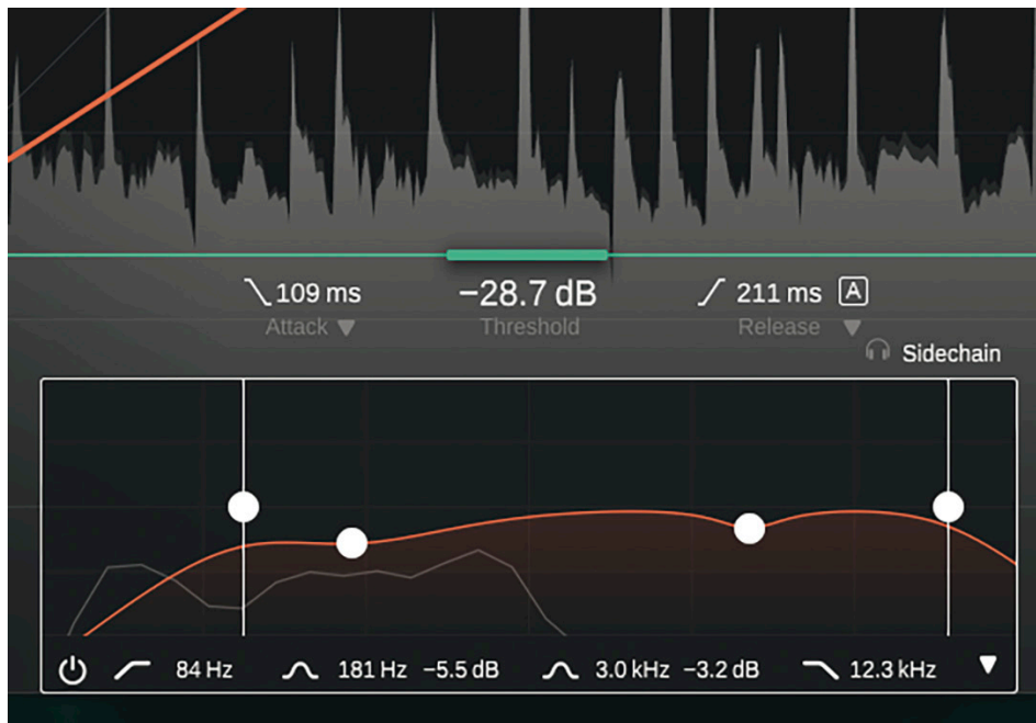
Abbildung 5: Sidechain-Filter mit High- und Low-Cut sowie zwei parametrischen Bändern
