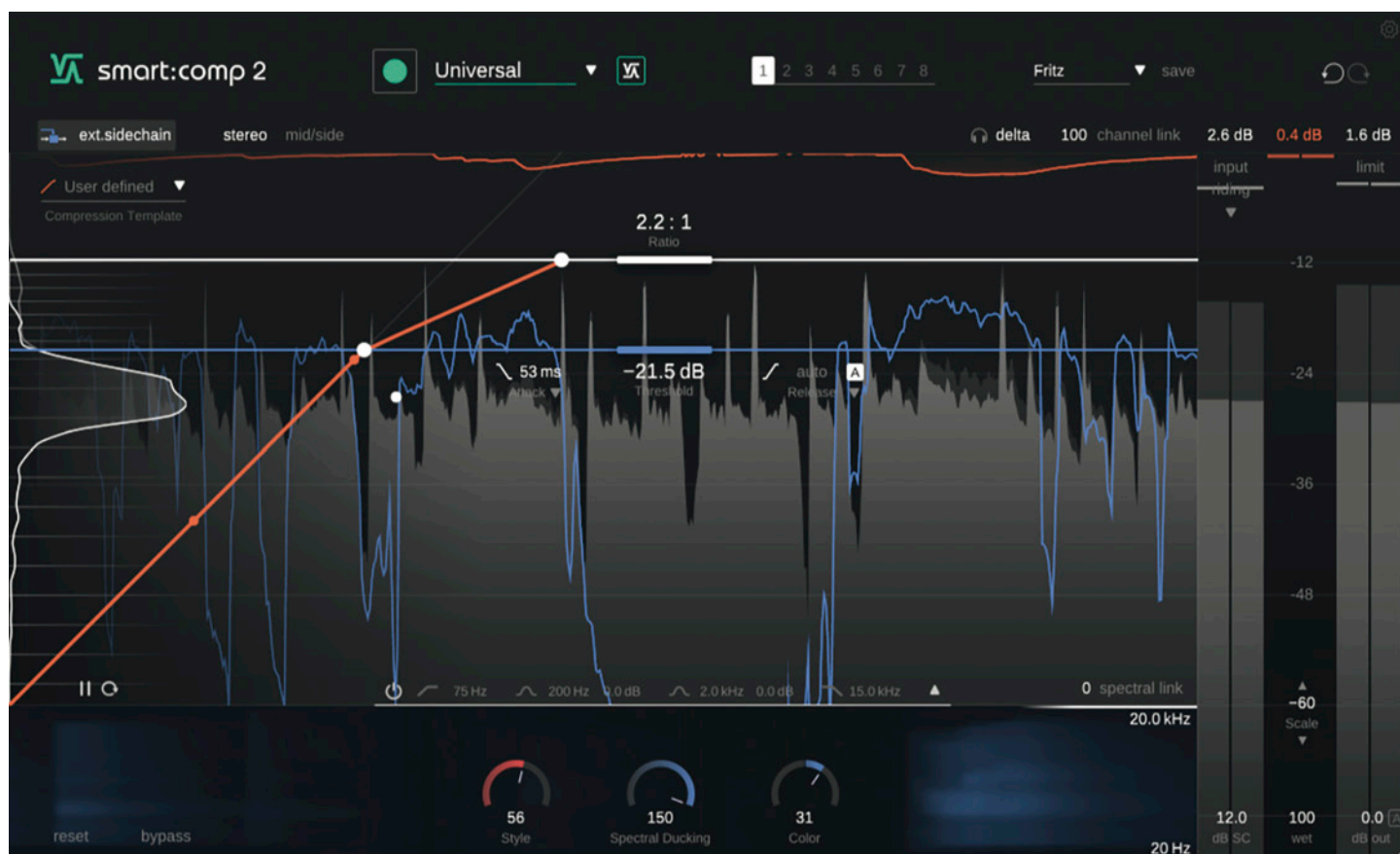
Abbildung 9: Sidechain Spectral Ducking Betrieb mit blau dargestelltem Verlauf des Steuersignals und spektraler Gewichtung
