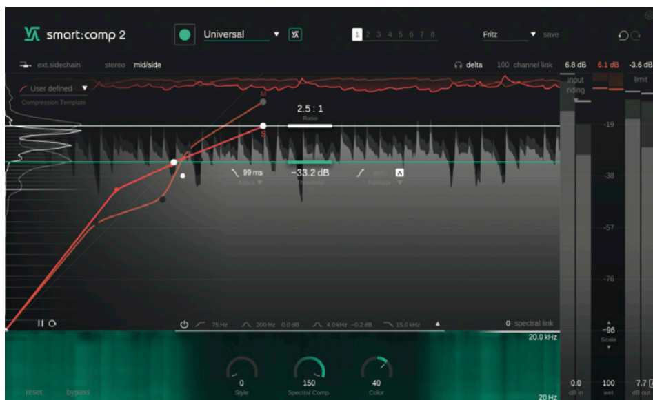
Abbildung 8: M/S Modus mit zwei parametrisierbaren Kompressorkanälen, die auch unterschiedliche Kennlinien haben können
