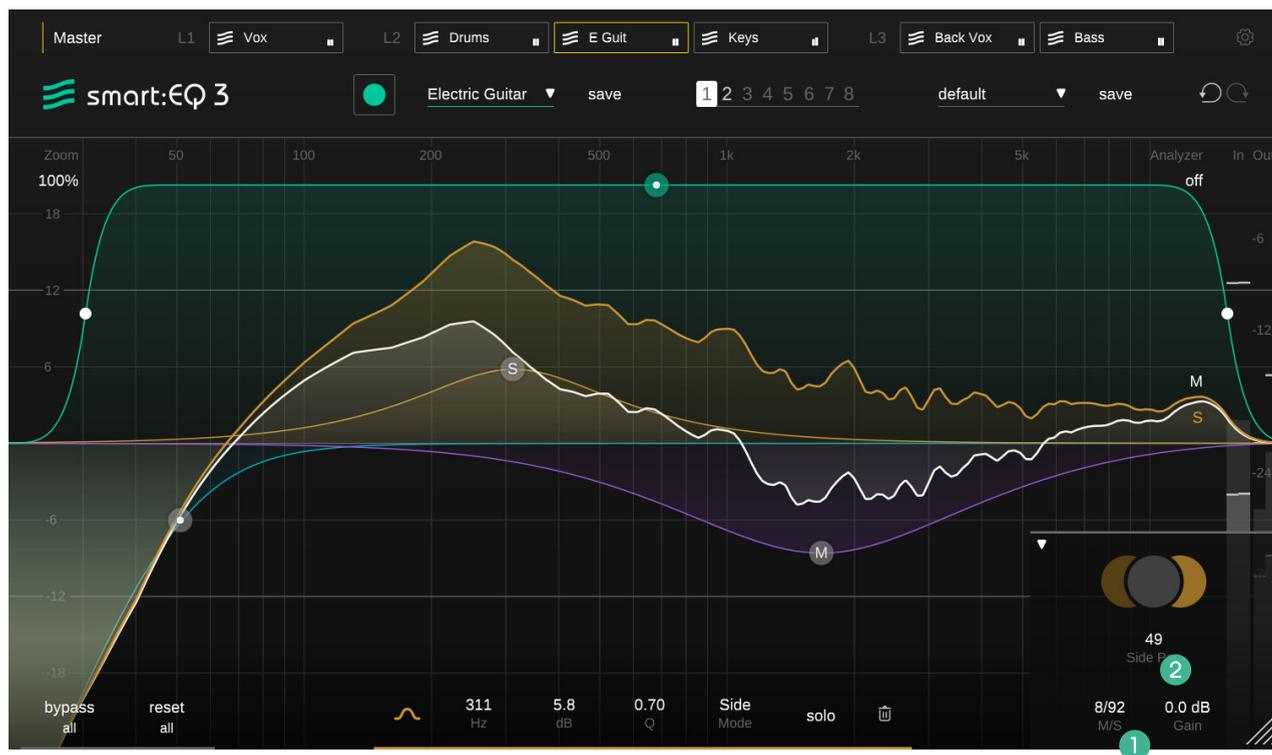
smart:EQ 3は、フルM/Sプロセッシングが可能です。各フィルターは、ステレオ、ミッド、サイドのいずれかのモードで使用することができます。さらに出力セクションには、M/Sバランスとサイドパンスライダーを使用してステレオイメージをコントロールするユニークなツールがあります。なお、これらのスライダーは、すべてのフィルターがステレオモードに設定されている場合でも使用可能です。
