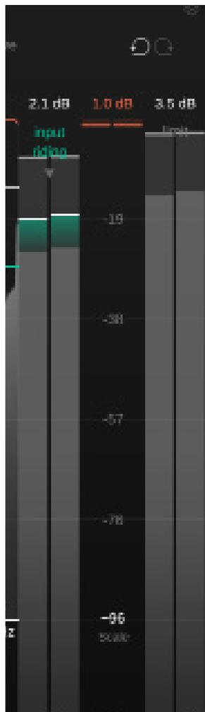
ラベルをクリックすると、インプットライディングが有効になります。インプットライディングが信号に与える影響は、インプットメーター内の緑のバーで確認できます。
