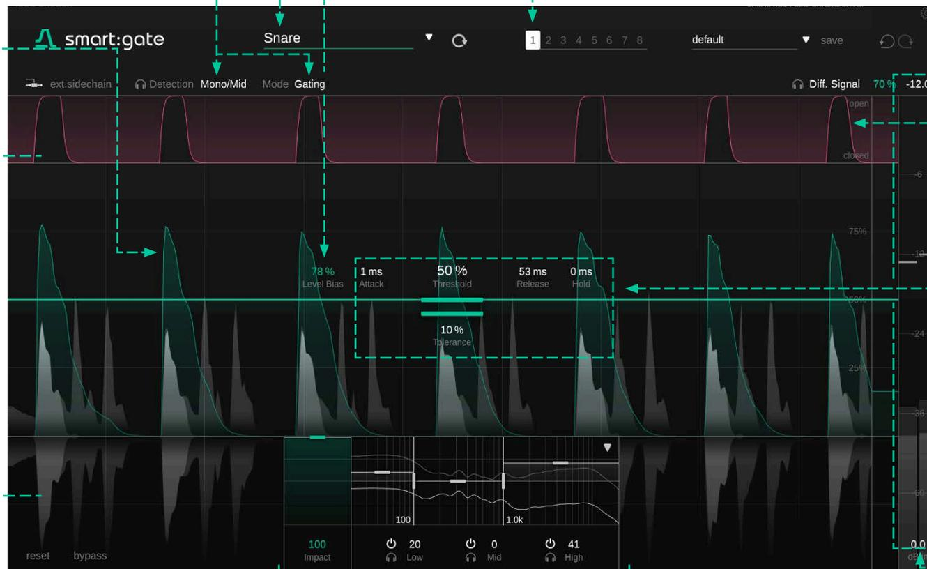
Aplicar gating pode ser uma tarefa complicada. Tipicamente, um gate analisa o nível geral de um sinal de entrada e abre quando o nível excede um determinado limite. Isso pode levar a problemas, pois o sinal que deveria abrir o gate (fonte alvo) bem como sinais de fundo indesejados geralmente variam de nível, dificultando ou até mesmo impossibilitando o ajuste de um limite de nível apropriado.
